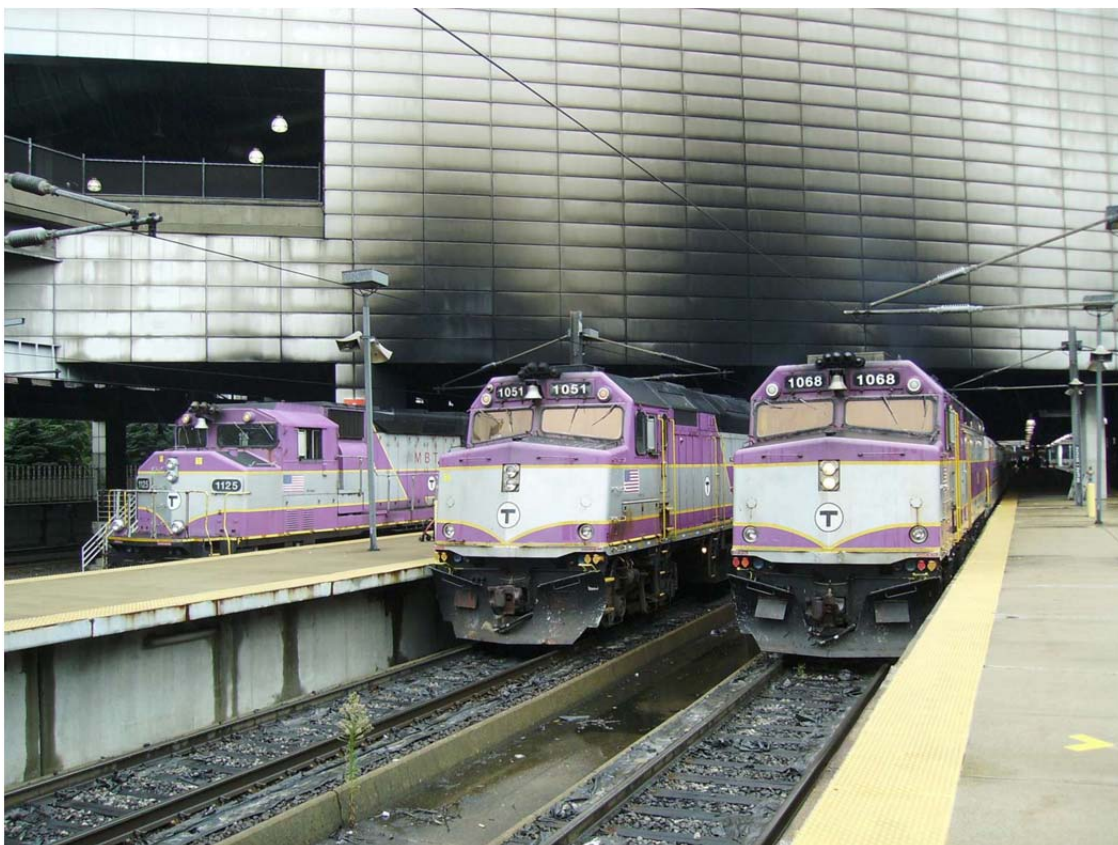
Foto 15 - Dal lato opposto alla semipilota, ecco le classiche motrici GP40 ( a sinistra ) ed F40PH, qui in livrea MTBA. I segni scuri sul muro sono dovuti agli scarichi dei motori di queste macchine
